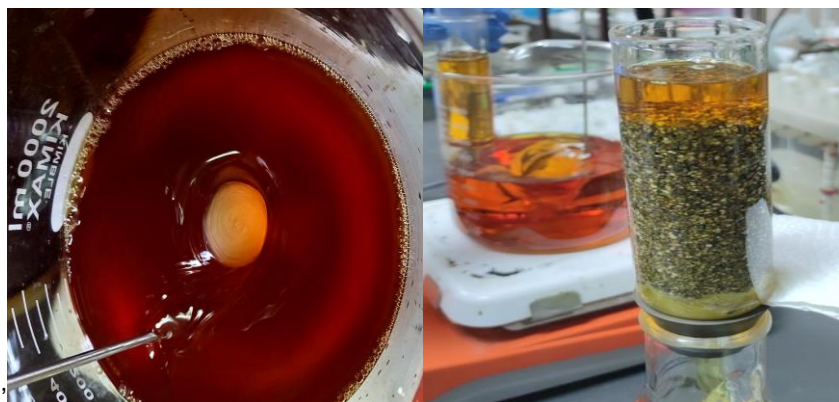
Slika 2. Ulje tokom postupka desulfurizacije (levo) i tokom završne obrade sa adsorbentom (desno)
