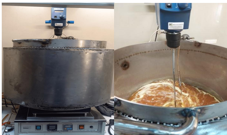
Slika 4. Pilot postrojenje za uklanjanje S_8 iz mineralnog izolacionog ulja
